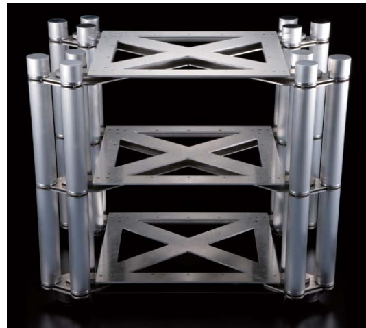
4隅に設置されたフルコンメカにアルミ製の棚板が載せてあり、この棚板が水平に動く仕組みになっている。さらに下側に見えるもう1枚アルミの板は4隅の支柱を固定するフレームで、上の棚板とはスパイク構造で組み合わさっている
